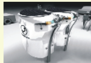
Telefono pubblico con accesso internet alimentato da pannelli fotovoltaici integrati
